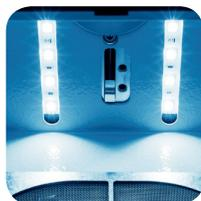
Il colore variabile dei led in camera di saldatura è inoltre un altro indice dello stato del laser. Gli stessi infatti cambiano il colore a seconda che il laser di trovi in stand-by, in funzionamento a bassa o ad alta potenza.
